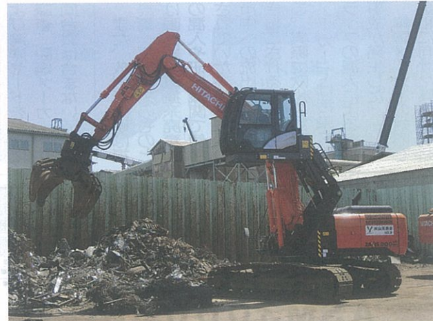
昨年12月に導入されたZAXIS200Oマグネット・グラブプル仕様機
